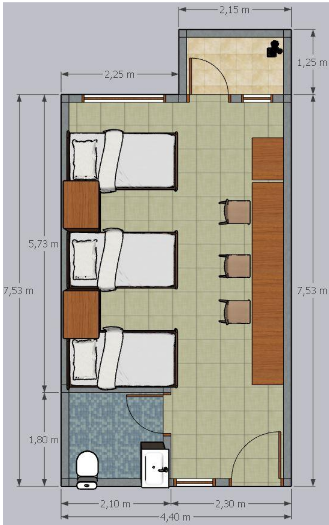
Gambar 3.1 Contoh tata letak unit dan minimum kebutuhan luas per unit tipe asrama PPLP.
